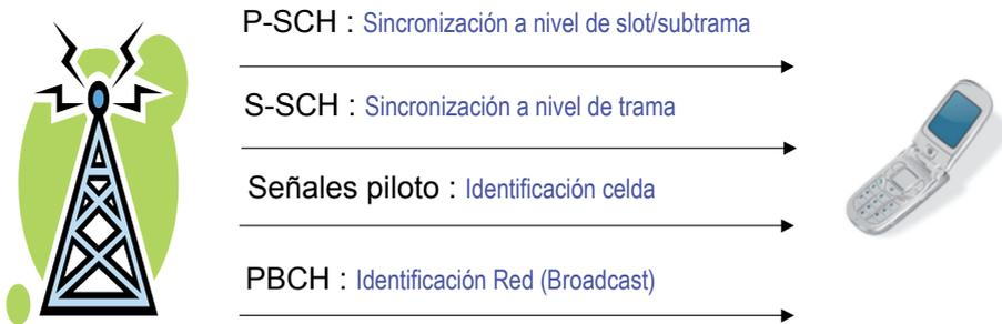
Figura 5-24 Procedimiento de sincronización y adquisición inicial de parámetros
