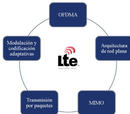
Figura 1-11 Componentes destacados de la interfaz radio LTE
